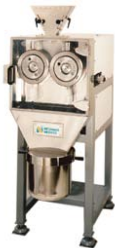
Рис. 4. Лабораторная дробилка LMW 100
